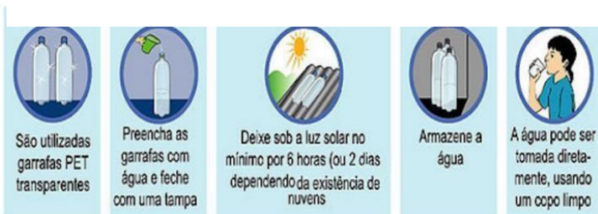
Figura 6 - Metodologia de tratamento SODIS
